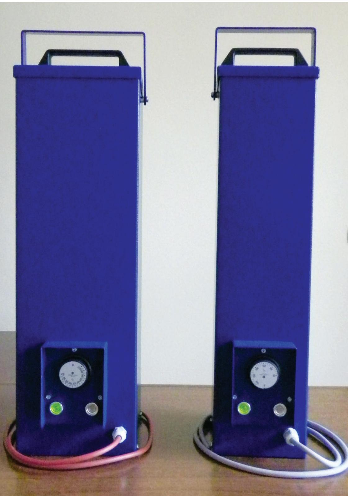
Forni portatili per il mantenimento degli elettrodi di Pipe & Weld Italy. / Portable keeping ovens for electrodes by Pipe & Weld Italy.
