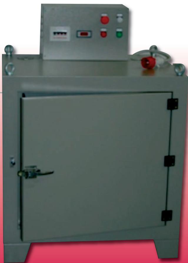
Il modello PWI-4E è un forno impiegato per l'essiccamento e il mantenimento degli elettrodi.
