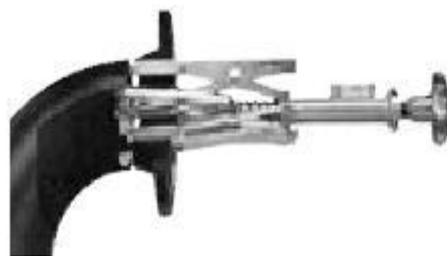
L'accoppiatore interno manuale per fissaggio flangia-curva **IMFC** ha un range di utilizzo da 2,25" (56 mm) fino a 20,4" (520 mm). L'IMFC è uno strumento pratico, facile e veloce da utilizzare.
