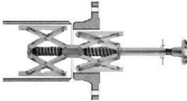
L'accoppiatore interno manuale per saldatura tubo-flangia **IMPC** ha un range da 2,25" (56 mm) fino a 37" (940 mm).
